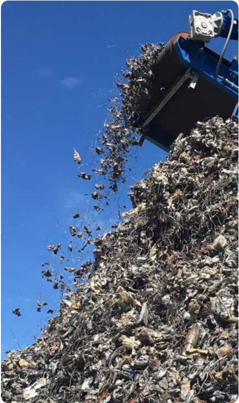
Proler, Materiale di risulta dalla lavorazione di rottame misto da un Mulino a Martelli >
